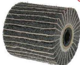
Con foro d'attacco Ø mm 19,1 e sede per chiavetta. Adatte per le più diffuse smerigliatrici, lucidatrici e satinatrici. In materiale fibroso combinato con lamelle in corindone. Per smerigliare, levigare e lucidare leghe al Cromo Nickel, leghe leggere, metalli dolci, legni ecc. Dimensioni mm 104x100. Velocità massima 6800 giri/min.
