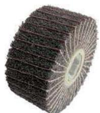
Con foro d'attacco Ø mm 19,1 e sede per chiavetta. Adatte per le più diffuse smerigliatrici, lucidatrici e satinatrici. In materiale fibroso combinato con lamelle in corindone. Per smerigliare, levigare e lucidare leghe al Cromo Nickel, leghe leggere, metalli dolci, legni ecc. Dimensioni mm 100x50. Velocità massima 6800 giri/min.
