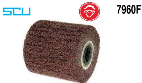
Con foro d'attacco Ø mm 19,1 e sede per chiavetta. Adatte per le più diffuse smerigliatrici, lucidatrici e satinatrici. In tessuto-non tessuto ad alta impregnazione. Abrasivo al carburo di silicio, per ottenere puliture di ruggini, sbavature di saldature, sverniciature di metalli, legni, intonaci, cemento. Non danneggia e non surriscalda la superficie da lavorare.
