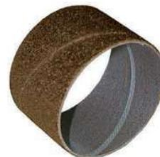
In Zircocorindone, velocità ottimale da 25 a 40 m/sec. Particolarmente sviluppato per la lavorazione dell'acciaio INOX e sue leghe, per ottenere maggiore asportazione e durata.
