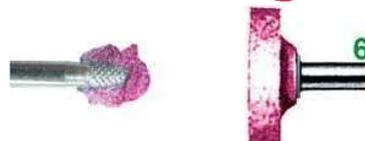
ATTACCO Ø mm 6, lunghezza mm 40. In CORINDONE bianco. Ottimo rapporto qualità/prezzo. Durezza M, con legante ceramico. Per uso su acciai extra duri per stampi, ghise acciaiose e cordoni di saldatura ecc.
