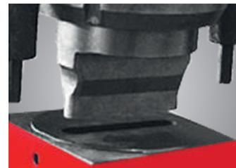
Dispositivo di punzonatura opzionale per grandi diametri
