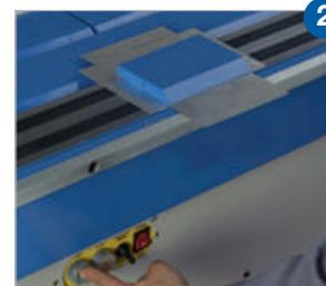
**Fase 2:** selezionare il segmento di piegatura, posizionarlo sul pezzo e attivare il magnete
