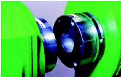
Ogni motore di questa macchina è dotato di un freno elettromagnetico che si sgancia automaticamente all'accensione del motore, utile nelle operazioni di sostituzione della spazzola
