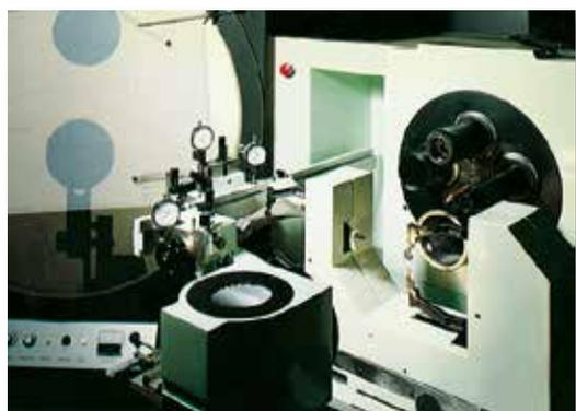
▲ Dispositivo **P4N**, comprendente il supporto palette ed il tastatore-ripetitore per il controllo di palette singole.
