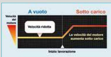
Questa scheda elettronica gestisce in autonomia la velocità di rotazione del motore e le conseguenti percussioni; ad esempio riduce sensibilmente la velocità del motore in fase di non lavoro (scalpello non in appoggio)
