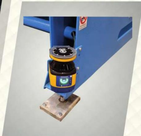
Protezione area cambio pallet con laser scanner di ultima generazione per ridurre al minimo l'ingombro della macchina
