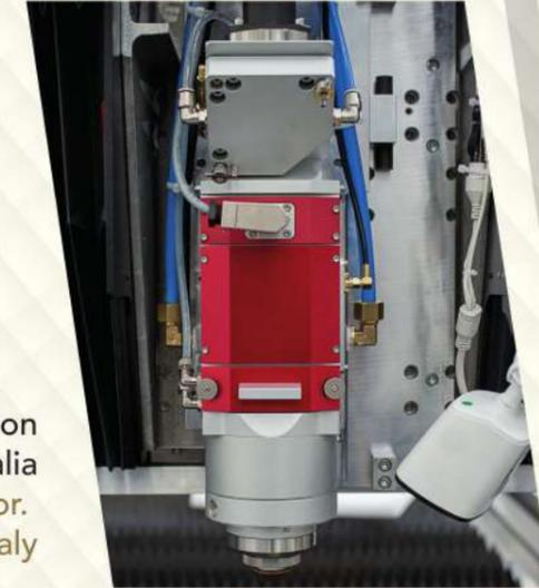
Testa di taglio Penta Fiber Head con sensore capacitivo. Progettata in Italia
