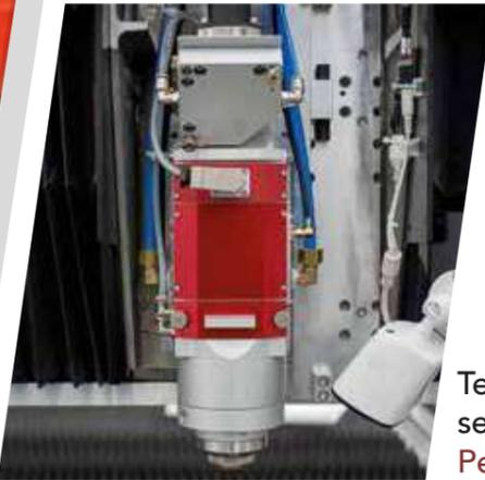
Testa di taglio Penta Fiber Head con sensore capacitivo. Progettata in Italia
