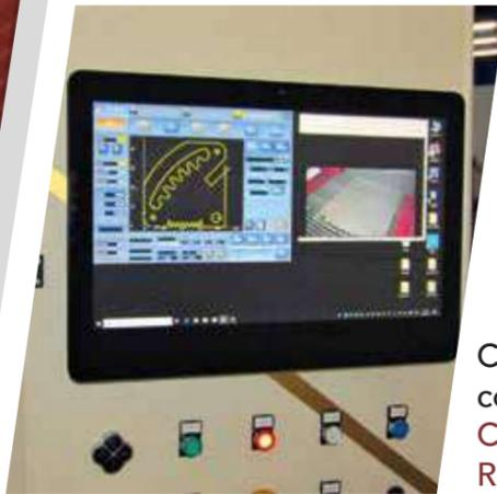
Controllo basato su pc industriale D.ELECTRON con possibilità di gestione tramite teleassistenza.
